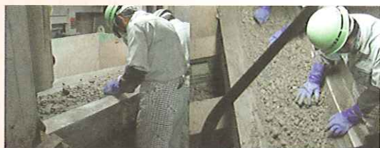
磁選機で取り除くことができなかった非鉄金属（アルミなど）を作業員が手で選別し取り除きます。
