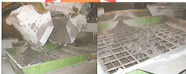
大きなふるいの機械にかけて、灰の中の大きな金属を取り除きます
