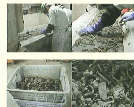
作業員が手で取り除いた非鉄金属(アルミなど)
