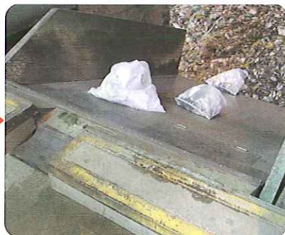
②鉄板が自動で下がりごみが滑り落ちます。
