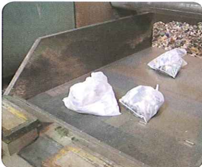
①鉄板の上にごみをおろす。
