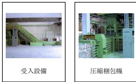
受入設備…収集されたペットボトルを圧縮梱包機へ送ります。
