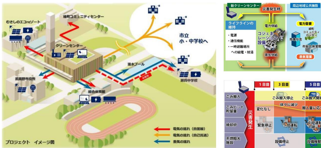
図 4-4-1 ガスコージェネレーション導入事例（武蔵野市）
